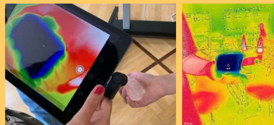
Der Eiswürfel wird dunkel blau als kältester Teil des Bildes dargestellt.
